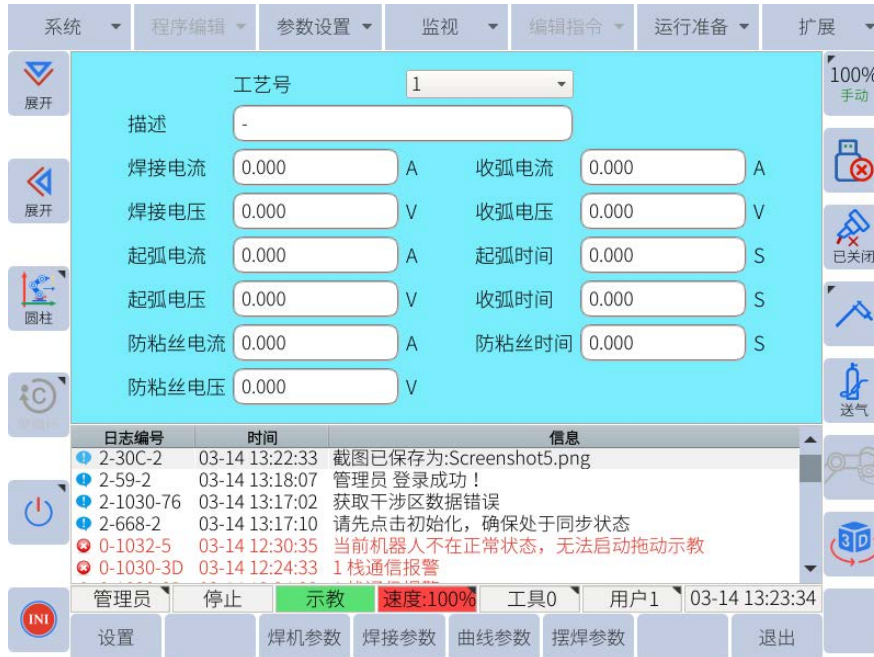
图 3-4：焊接参数界面及其设置
